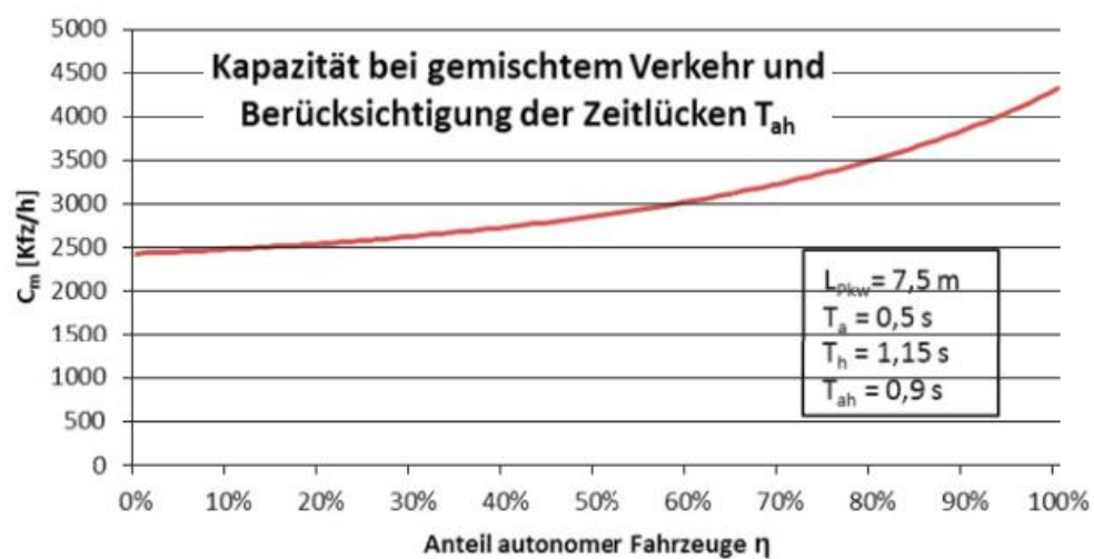
Abbildung 5-6: Kapazität eines Fahrstreifens in Abhängigkeit des Anteils autonomer Fahrzeuge bei reinem PW-Verkehr unter Berücksichtigung grösserer Folgezeitlücke von autonomen Fahrzeugen auf von Fahrern gelenkte Fahrzeuge
